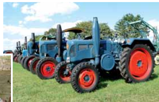
In Reihe und Glied: Das Erfolgsgeheimnis des Lanz Bulldogs lag in seiner einfachen Konstruktion, seiner Zuverlässigkeit und Robustheit. Das markante Auspuff-Bullern der Traktoren erzeugt, je nach Typ, ein Einzylinder-Dieselmotor mit bis zu 13,8 Litern Hubraum.
